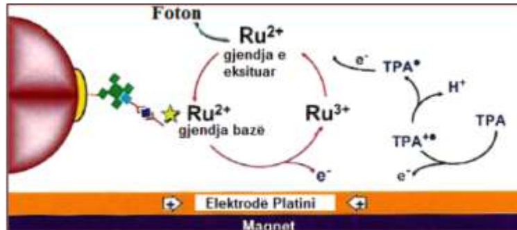
Figura 2.2: Fazat e amplifikimit të sinjalit në reaksionin ECL.
