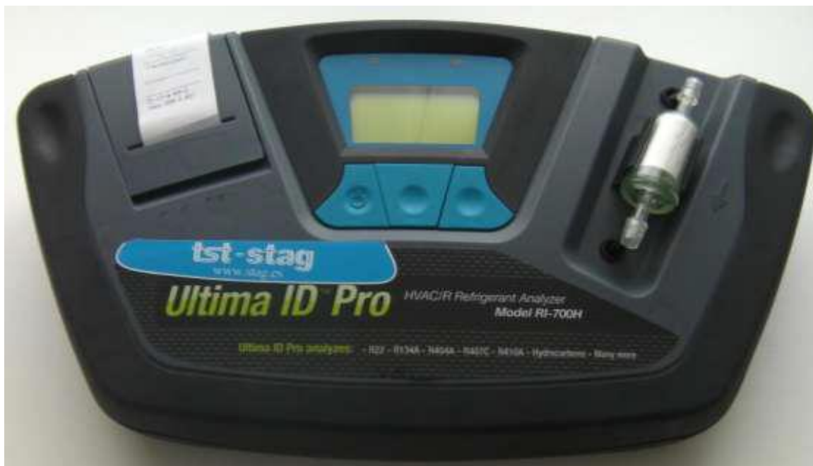
Figura 7.3 Pamja e jashtme e analizatorit të substancave ozonholluese Ultima ID Pro RI-700H.
