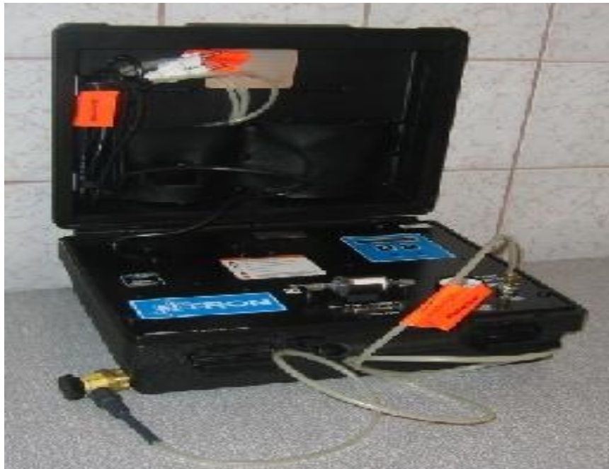
Figura 7.1 Pamja e jashtme e analizatorit të substancave ozonholluese Neutronics RI-2002PA.
