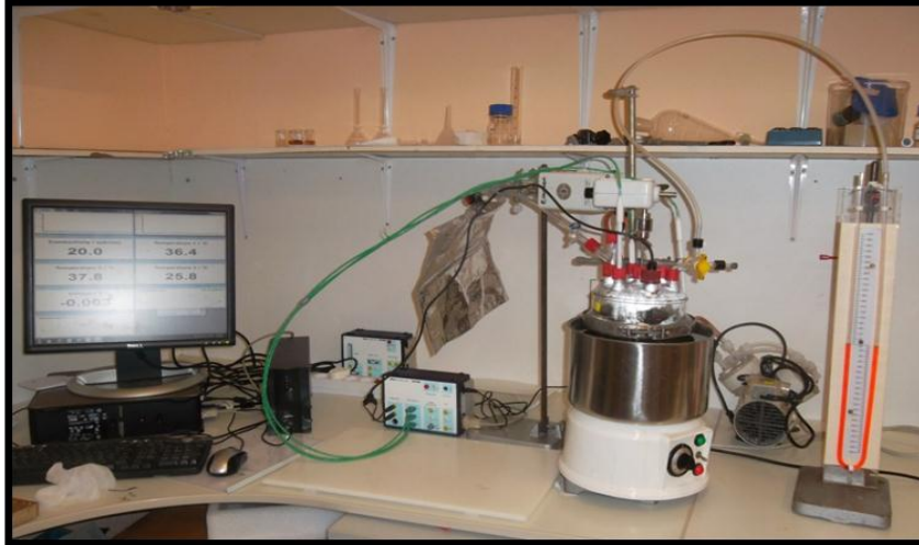
Figura 4.2 Skema e reaktorit ku zhvillohet procesi i kompostimit
