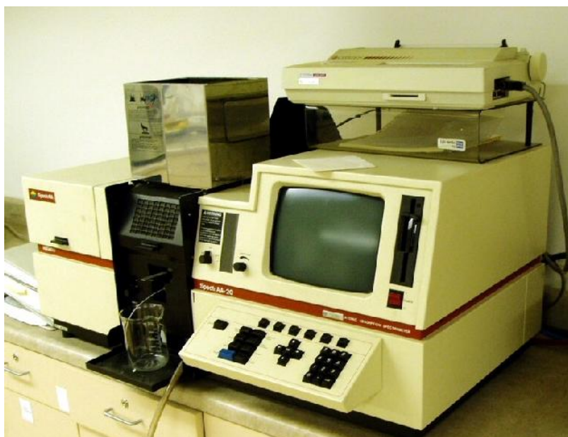
Figura 5.1 Spektrometri VARIAN Spect.AA-20, i përdorur për analizimin e metaleve të rëndë
